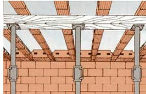
Am Auflager eingehängte Ziegel dienen als Abstandhalter. Die Verlegereihenfolge und Detailausführungen sind dem Verlegeplan zu entnehmen. Montageunterstützungen sind nach dem im Verlegeplan angegebenen Abständen aufzustellen. Bei Spannweiten über 4 m ist eine Überhöhung von ca. 1,5 cm vorzusehen, damit die Decke nicht optisch durchhängt.
