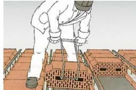
Deckenziegel werden in ausreichender Menge geliefert. Bei Querrippen, Balkonen, Abfangungen usw. ist der Einbau von Negativziegeln (Ziegel mit geringerer Stärke als Deckenstärke) und Zulageeisen zu beachten. Genaue Angaben über Lage und Ausführung der Querrippen finden sich im Verlegeplan. Während der Arbeiten, besonders beim Einbringen des Betons, sind Punktbelastungen zu vermeiden oder durch Bohlen zu verteilen.
