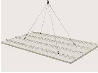
Die Lücking Plattendecke ist eine Deckenplatte mit Ortbetonergänzung nach DIN EN 13747. Sie besteht aus großformatigen 5–7 cm dicken Fertigplatten, die durch Ortbeton ergänzt werden. Die Gitterträger bilden das für den Transport und die Montage aussteifende Element.
