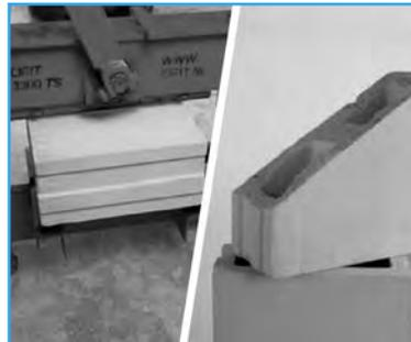
Die Steine lassen sich problemlos in Höhe, Länge und Diagonale mit einem Spalter „knacken“. Ausgleichsteine sind überflüssig.
