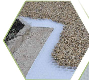
Diese Kiesplatte kann mit Hand- oder Stichsäge passgenau zugeschnitten und lückenlos an Hindernisse gelegt werden. Die Waben mit Kiesel füllen, mit einem Rechen nivellieren und dann noch eine Kieselschicht auflegen.
