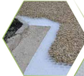
Diese Kiesplatte kann mit Hand- oder Stichsäge passgenau zugeschnitten und lückenlos an Hindernisse gelegt werden. Die Waben mit Kiesel füllen, mit einem Rechen nivellieren und dann noch eine Kieselerschicht auflegen.
