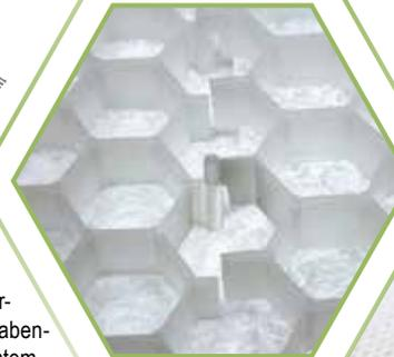
Die Kiesplatte erlaubt einen stabilen Unterbau mit hoher Wasserdurchlässigkeit zu bauen. Die wabenförmige Struktur aus hochdichtem Polyethylen schafft einen UV- und frostbeständigen Unterbau. Das dazugehörige Geotextil-Vlies verhindert Unkrautwuchs.
