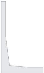
Die Stützwinkel sind in Versetzbreite 50 cm und 100 cm in folgenden Höhen als Normalteil und die Außenecke zweiteilig (100 cm x 100 cm) mit einer zweifachen Gehrung (45°) erhältlich:
