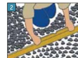
Bettung darf nicht mehr betreten werden und muss schon jetzt dasselbe Quer- und Längsgefälle aufweisen wie der spätere Plattenbelag. Fehlstellen nach dem Herausnehmen der Rohre wieder auffüllen.
