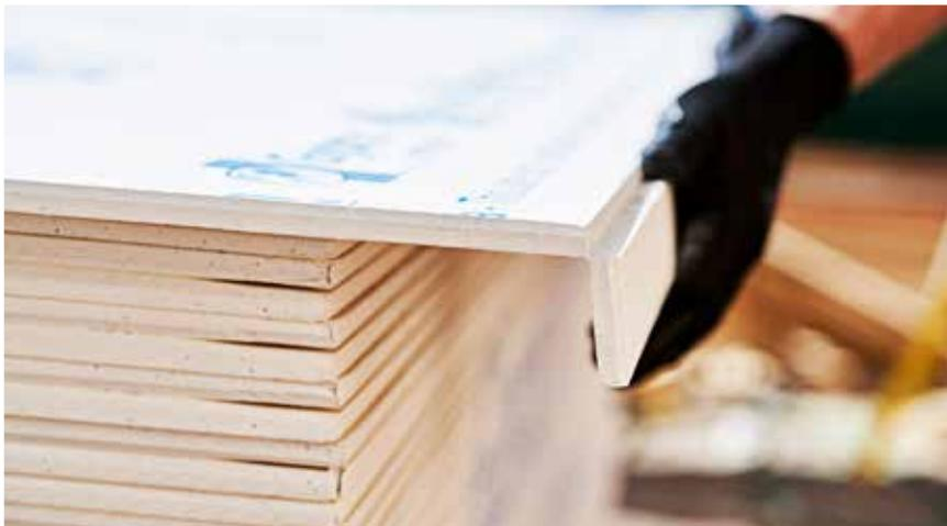
Schneller und sicherer Baufortschritt: Im Vergleich zu sonstigen Plattenwerkstoffen im Außenbereich weist Glasroc X ein deutlich geringeres Gewicht auf, was die Verarbeitung spürbar vereinfacht. Die Platten können problemlos angeritzt und dann exakt an der Schnittkante gebrochen oder mit einer Kreissäge und Führungsschiene zugeschnitten werden.
