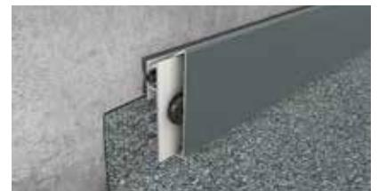
Wandanschlussprofile dienen zur mechanischen Fixierung von Dachabdichtungen an aufsteigenden Mauerwerken. Das Wandanschlussprofil Okto wird mit einer Länge von 2000 mm und einem Lochabstand von 200 mm geliefert. Damit ist eine schnelle und sichere Montage gewährleistet. Bei diesem Profil haben wir besonderen Wert darauf gelegt, dass sie regelkonform verarbeitet werden kann.
